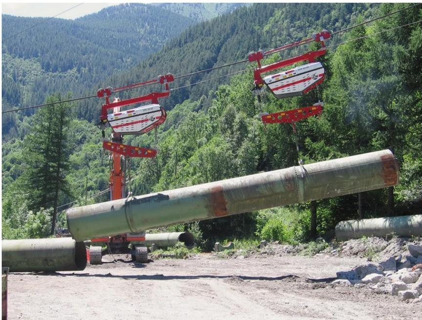
*Рис. 2 – Быстровозводимые грузопассажирские канатные дороги системы «Грифон»*
