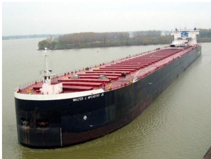
Рис. 3. Углевоз «Walter J. McCarthy Jr.» – однопалубный сухогруз для перевозки каменного угля
