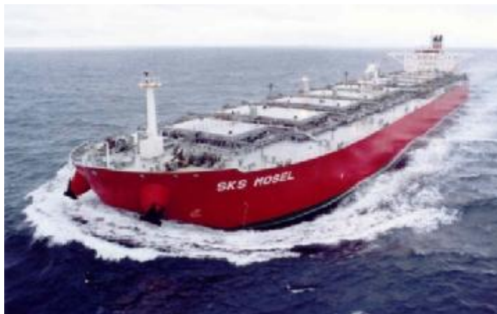
Рис. 5. Нефтерудовоз типа ОБО (Oil/Bulk/Ore carrier) – судно для перевозки нефти, относительно легких навалочных грузов и руды «SKS Mosel»
