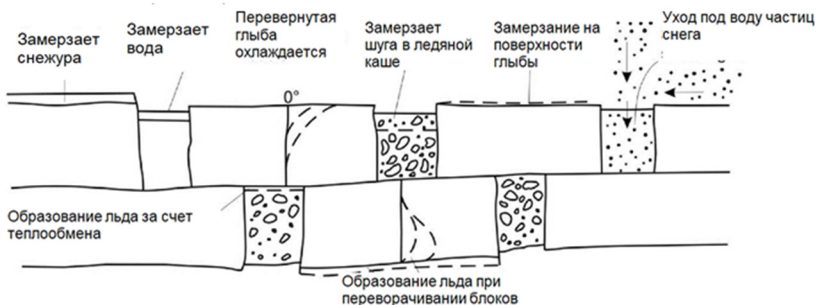
Рис. 3. Механизмы, способствующие ускоренному нарастанию ледяной каши
