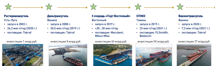
Рис. 2. Характеристики реализации проектов экспортных угольных терминалов в РФ в период с 2003 г. по 2021 г.
