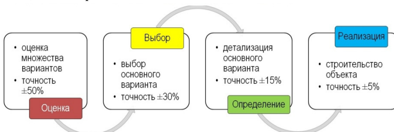
Рис. 1. Многостадийный подход управления крупными промышленными проектами
